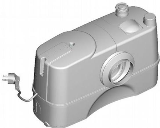
Бачок герметичный и может 15 мин. держать давление 0.08bar (0.8m) без протекания.....
